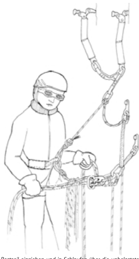
Restseil einziehen und in Schlaufen über die unbelastete Selbstsicherung legen. In den Zentralkarabiner die Sicherung des Nachsteigers einhängen (Plate). Kommando „NACHKOMMEN!“
