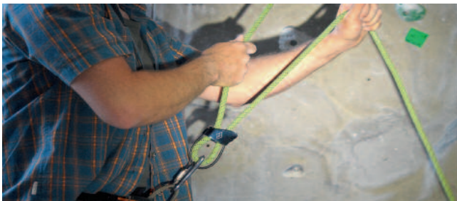
Abb. 5 Momentaufnahme von einem korrekten Sicherungsvorgang mit Smart. Die Sicherheitsfunktion ist aufgehoben.
