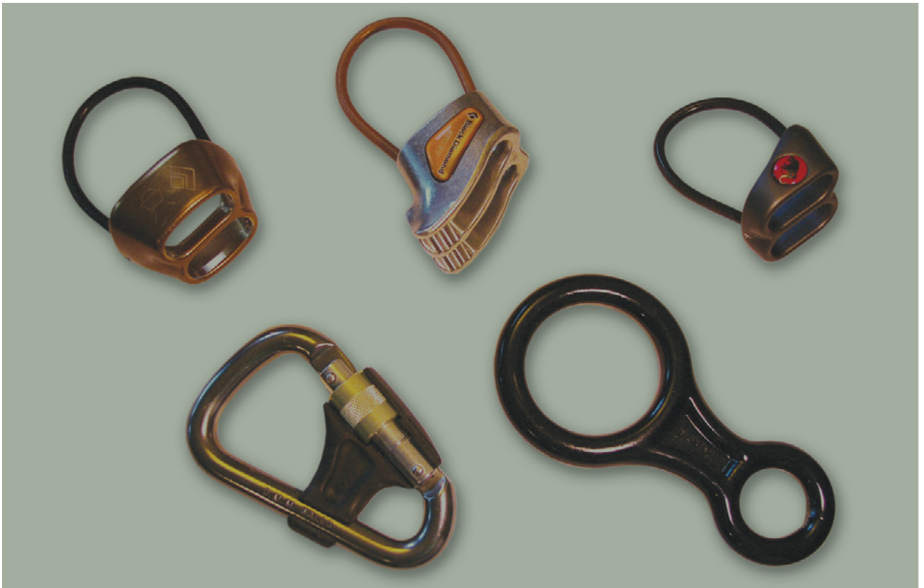
4 Die getesteten Sicherungsgeräte: ATC ("Air Traffic Controller") und ATC-XP von Black Diamond, Fuse von Mammut, HMS-Belaymaster von DMM und Achteck von Mammut.
