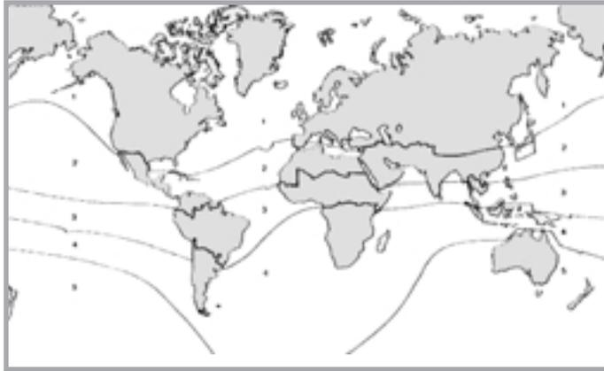
Die Karte zeigt die fünf Inklinationszonen der Erde. Die Kompasshersteller wirken dieser Kippneigung (Inklination) entgegen, indem der Schwerpunkt der Nadel je nach Zone verschieden ausgeführt ist. Bei einem Kompass, der für unsere Breiten vorgesehen ist, können auf der Südhalbkugel deshalb Messfehler entstehen, da die Nadel am Gehäuse streift. Einen Ausweg bieten Kompass mit einem Rundmagnet.
