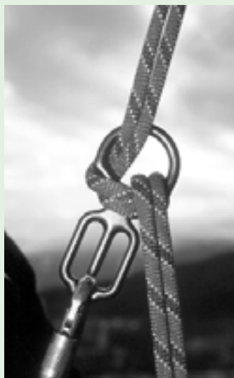
Abseilgeräte wie der Guide (links) oder der Multigrip (rechts) ermöglichen zwei unterschiedliche Bremsstufen. Abhängig von Körpergewicht, Seildurchmesser und Abseilgelände bietet sich die „Hard“- oder die „Light-Version“ an. Die deutlichste Bremskraftverstärkung bietet der Guide durch die Kombination von Achter und Plate. Alle 📷 Schantl
