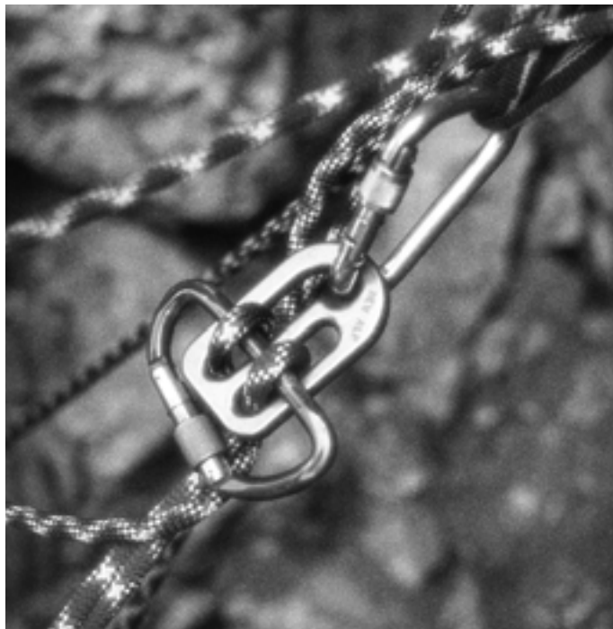
Abb. 3: Die Sicherungsplatten (hier Magic Plate) sind ideal, wenn es gilt, zwei gleichzeitig nachsteigende Kletterer zu sichern, die jeweils an einem Halbseilstrang klettern. Durch die selbsttätige Wirkungsweise ist es möglich, jeweils den gerade lockeren Seilstrang einzuziehen und es ist bei unterschiedlicher Klettergeschwindigkeit der Nachsteiger nicht notwendig, immer beide Seilstränge in den Händen zu halten. (Foto: M. Larcher)
