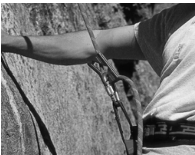
Abb. 4: Bei uns völlig unbekannt, das ABS, ein selbsttätiges Sicherungsgerät aus Frankreich in äußerst einfacher Bauweise, das zudem dynamisch wirkt. In der Anleitung verspricht eine Grafik Bremskraftwerte in der Größenordnung von ca. 2,5 kN. Allerdings ist das Handling derart gewöhnungsbedürftig, dass man gerne wieder Abstand nimmt.
