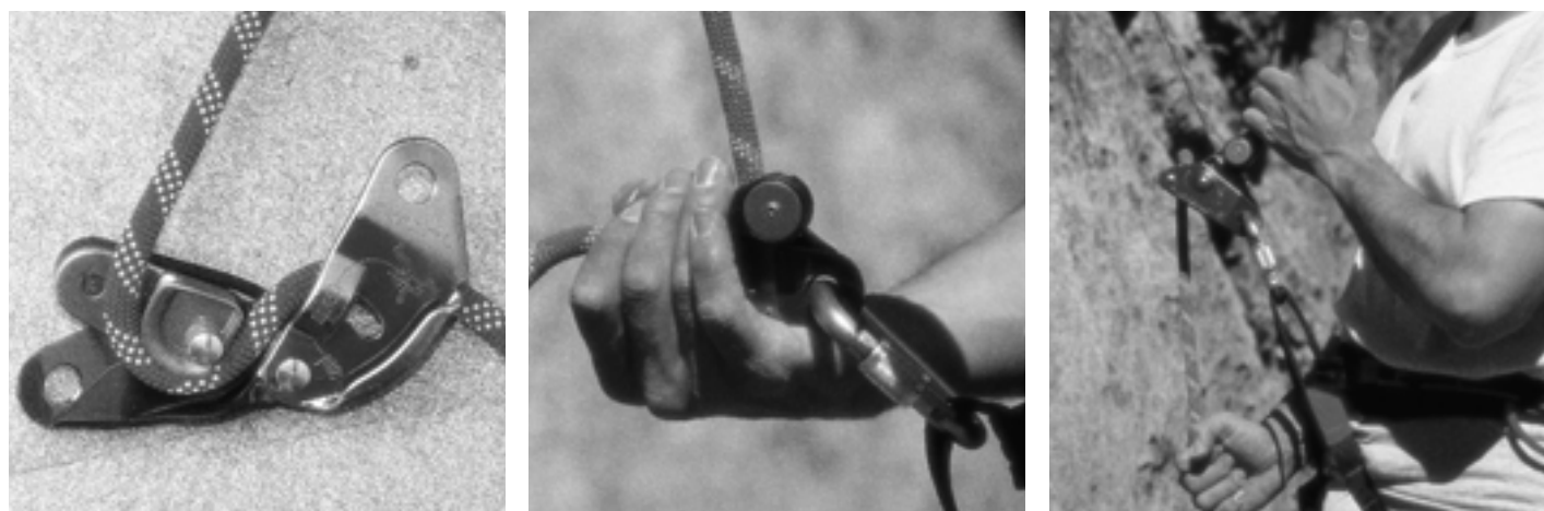
Abb. 2: Die Risiken beim Grigri sind versteckter und damit heimtückischer als bei anderen Sicherungsgeräten. 1. Falsches Seileinlegen (links): Die Gefahr lässt sich durch einen Funktionstest im Rahmen des standardisierten Partnerchecks ausschalten. 2. Der Sichernde blockiert die Bremsautomatik (mitte): Diese Gefahr lässt sich ausschließen, indem man entweder konsequent nur mit beiden Händen am Seil arbeitet oder indem man das Gerät nur seitlich fixiert, so, dass es einem durch den Sturzzug sofort aus der Hand gerissen wird. 3. Unsachgemäßes Ablassen (rechts): Der Hebel am Grigri ist zum Entriegeln gedacht, nicht zum Steuern der Ablassgeschwindigkeit. Die Geschwindigkeit wird immer durch jene Hand gesteuert, die das einlaufende Seil bedient. (Fotos: H. Zak)
