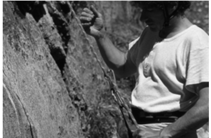
Abb. 5: Ein ganz anderes Bremsprinzip wurde von Cassin vorgeschlagen: ein sich verengender Schlitz, in den bei einem Sturz das Seil - fast von selbst - gezogen wird. Fotos: H. Zak
